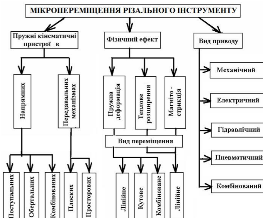
Рис. 1. Класифікація основних принципів здійснення мікропереміщень різального інструменту
